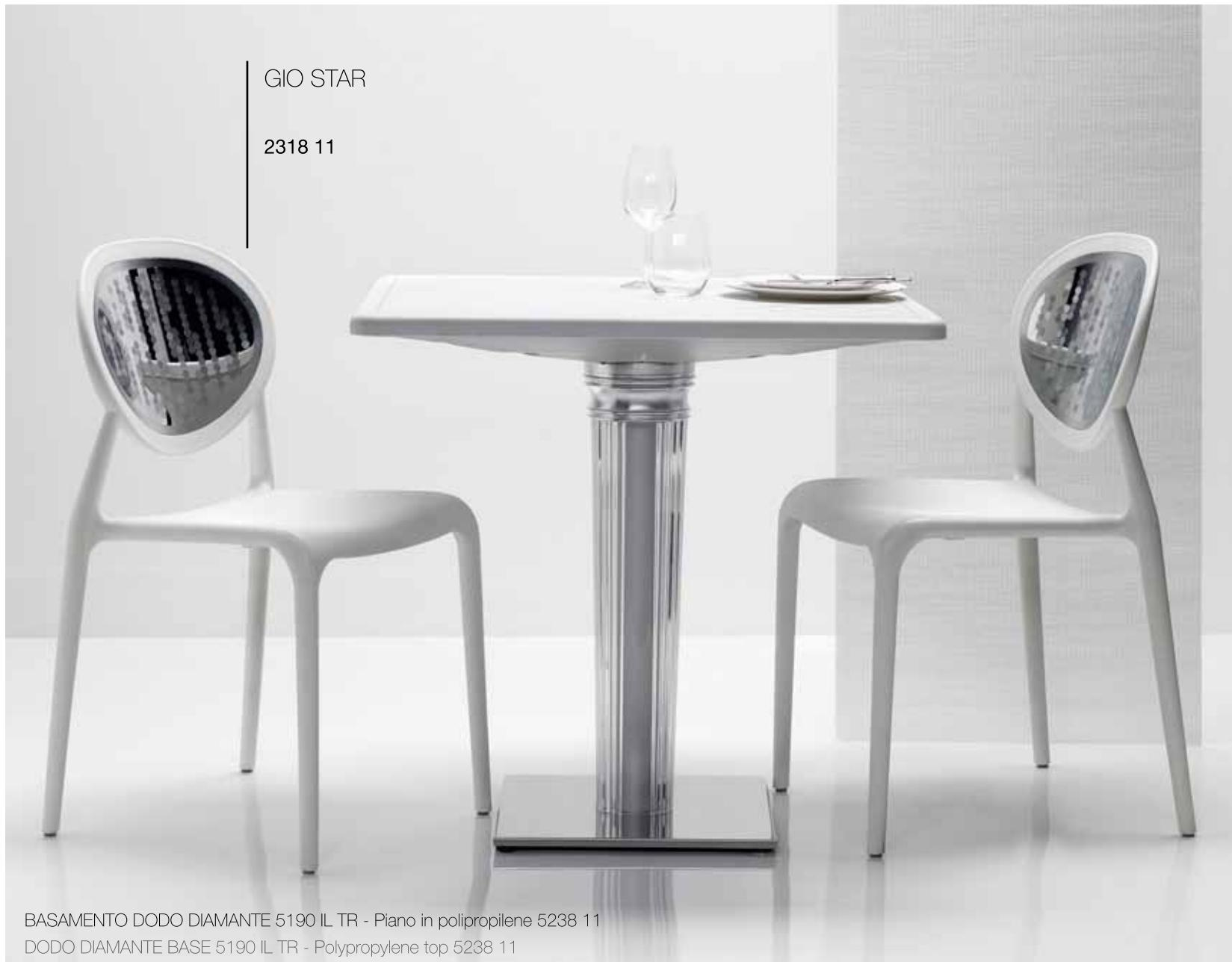
Struttura in tecnopolimero rinforzato fibra di vetro. Stampata ad iniezione con tecnica air moulding, schienale in ABS cromato.
